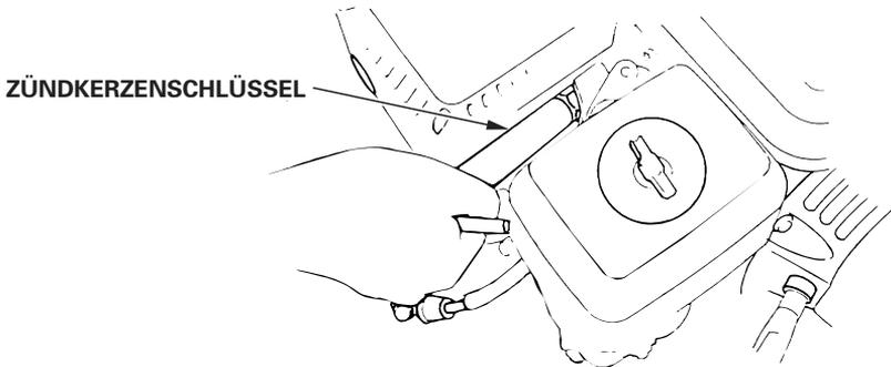
3. Die Zündkerze einer Sichtprüfung unterziehen. Eine Zündkerze, die abgenutzt ist, oder deren Isolator Risse bzw. Absplitterungen aufweist, muss ausgewechselt werden. Wenn die Zündkerze wieder verwendet werden soll, mit einer Drahtbürste reinigen.
