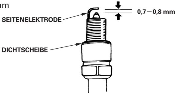
5. Sicherstellen, dass sich die Dichtungsscheibe in gutem Zustand befindet, und die Zündkerze von Hand eindrehen, um ein Verdrehen des Gewindes zu vermeiden.
