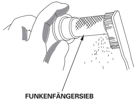
3. Ölkohleablagerungen mit einer Bürste vom Funkenschutzsieb entfernen. Darauf achten, das Sieb nicht zu beschädigen.
